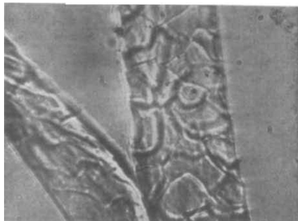
Bild 1. Wollfaser, nicht behandelt. (Vergrößerung sämtlicher Bilder ca. 700 fach.)
